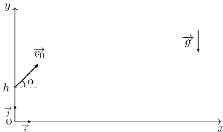
Figure 8.1 – Schéma d'une chute libre en deux dimensions
